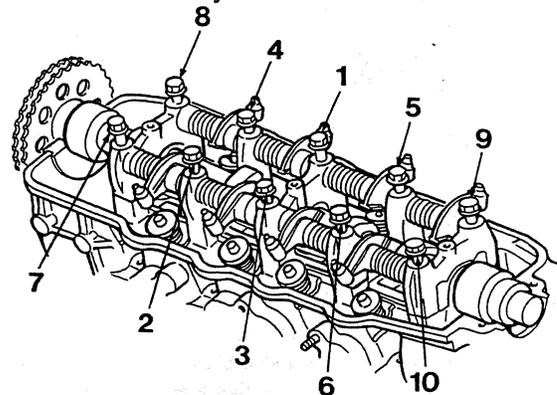
**CYLINDER HEAD BOLTS TIGHTENING TORQUE:**
