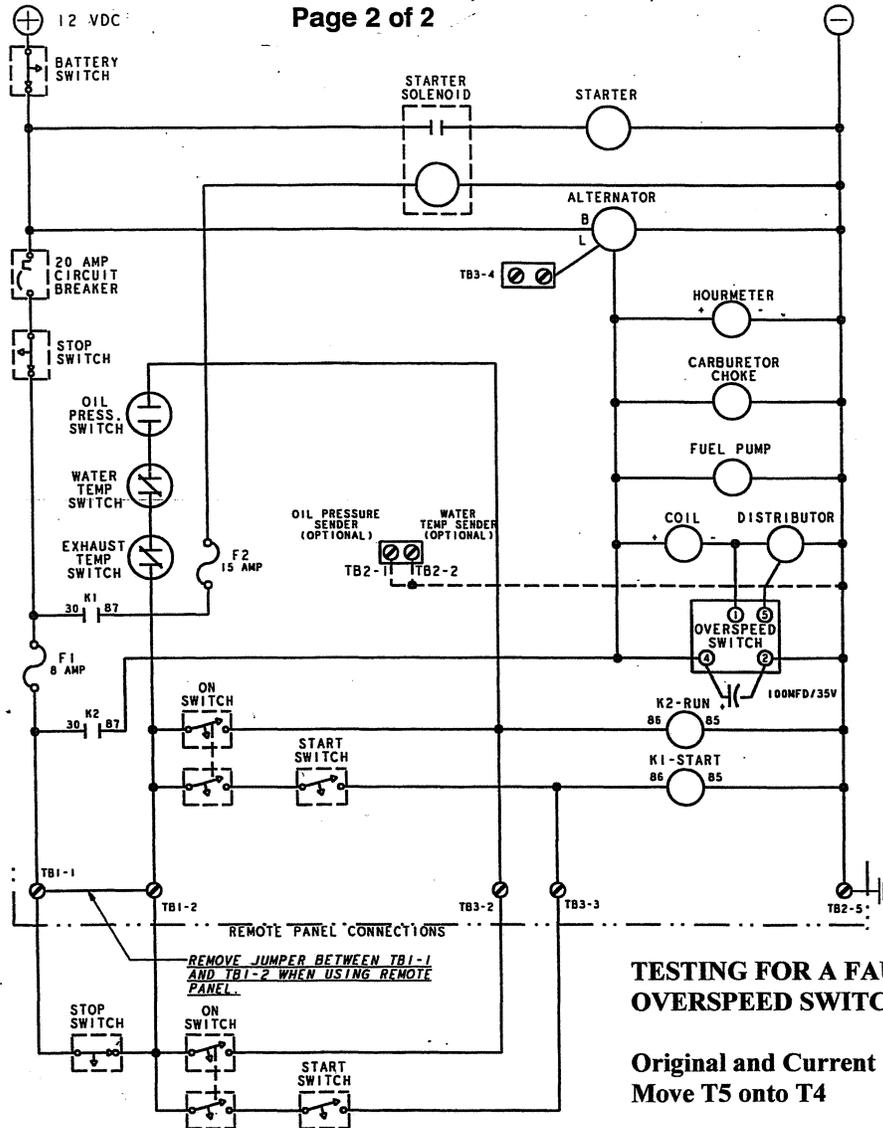
**TESTING FOR A FAULTY OVERSPEED SWITCH:**
